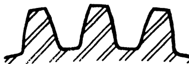
Paso Diametral 5 Paso Circular de .6283"
