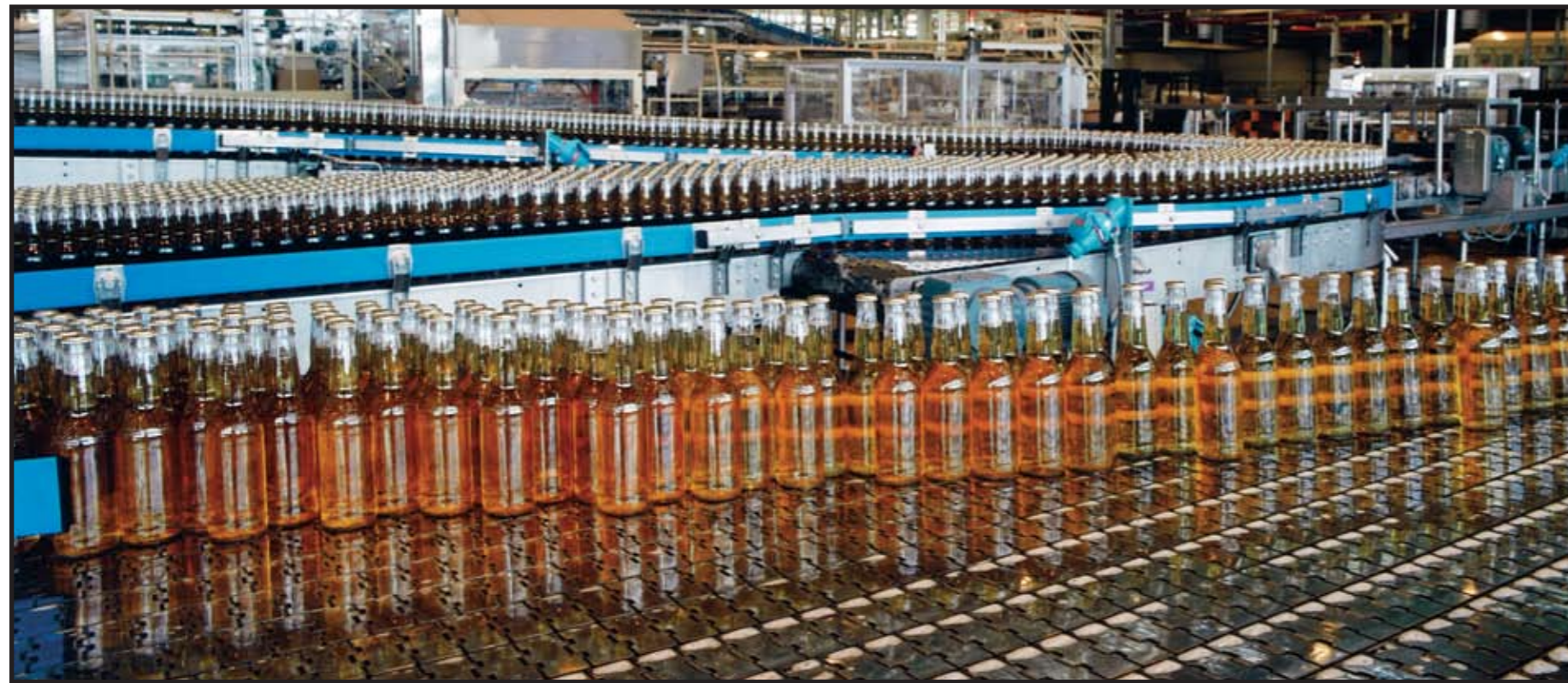
Nueva cadena metálica serie X-Line en un alineador de una cervecera
